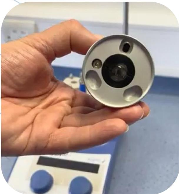
各 fReactor Photo module は、各 CSTR の上に直接設置できます。
